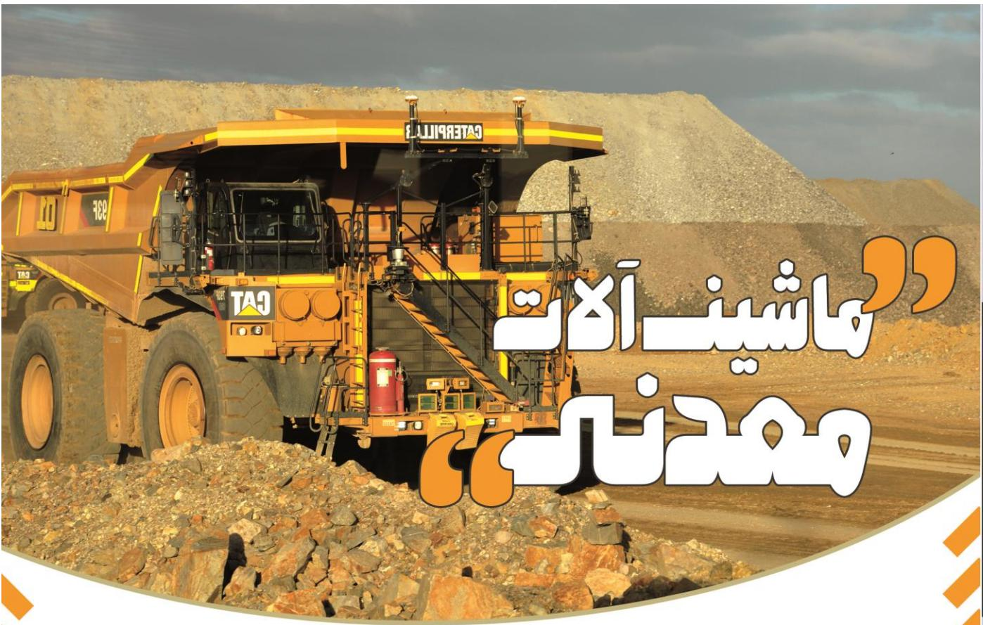
و خود اون ژنراتور هم ۳۰٪ اتفال انرژی داشته تا تبدیل به انرژی الکتریکی بشه و در انتقال هم ۱۰٪ رواز دست می دهد. علت استفاده از نیروی الکتریکی این هست که میشه با هرگشتاوری که رو محور موتور اعمال بشه باز هم اون روراه اندازی کرد.
