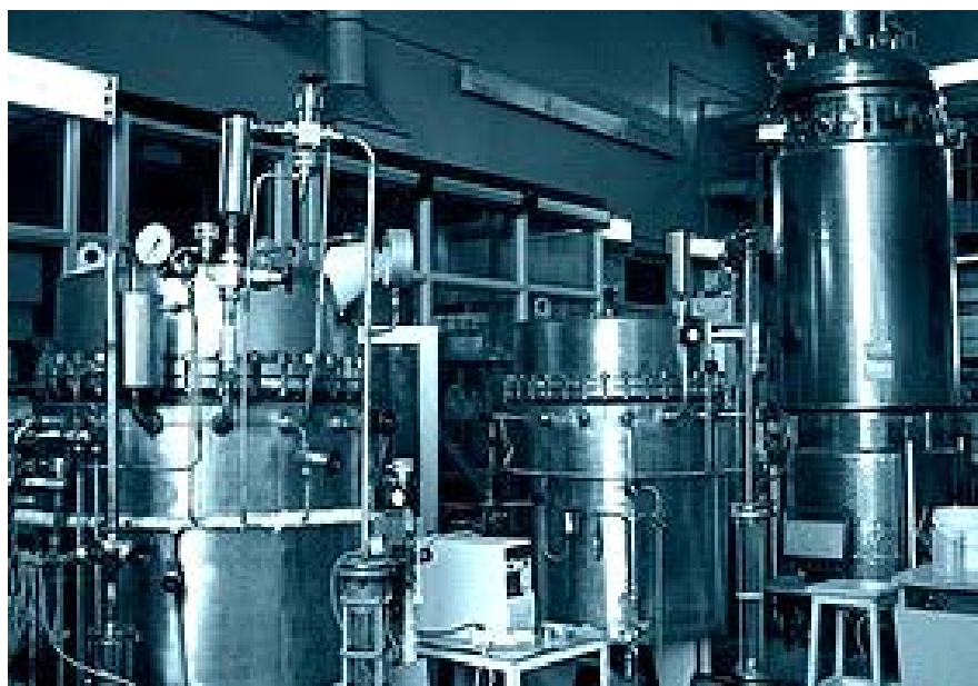
بیوراکتورهای صنعتی برای کشت سلول‌های زنده گیاهی، جهت تولید متابولیت‌های ثانویه
